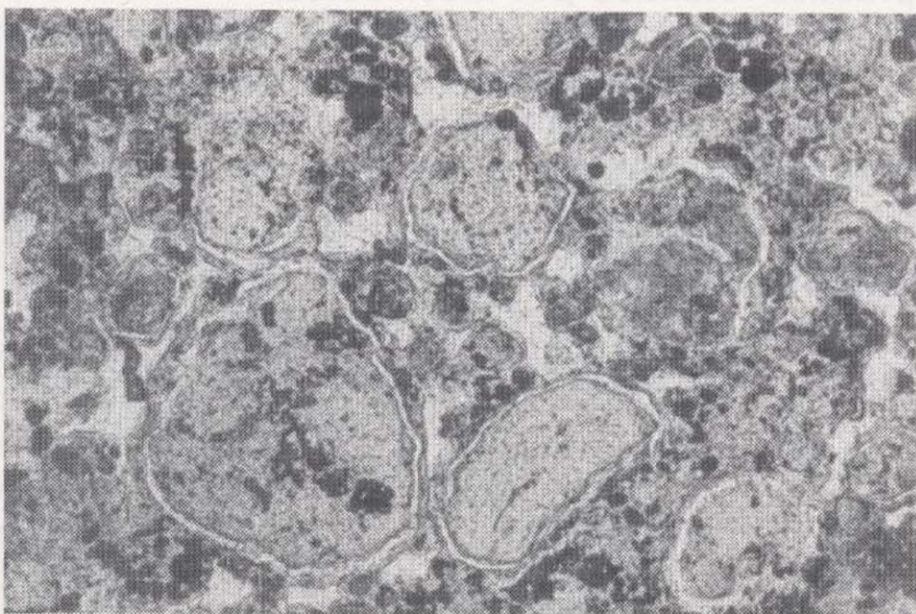
Figura 7. Aspecto petrográfico de la litofacies de intrarenitas, con morfologías intraclásticas de diverso tamaño y material geliforme asociado. (N//).
